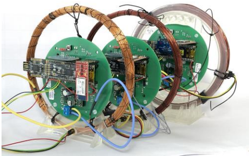
Abb. 1 Individual Magnet-Feld Generator (128 Watt) mit integrierter Messelektronik
