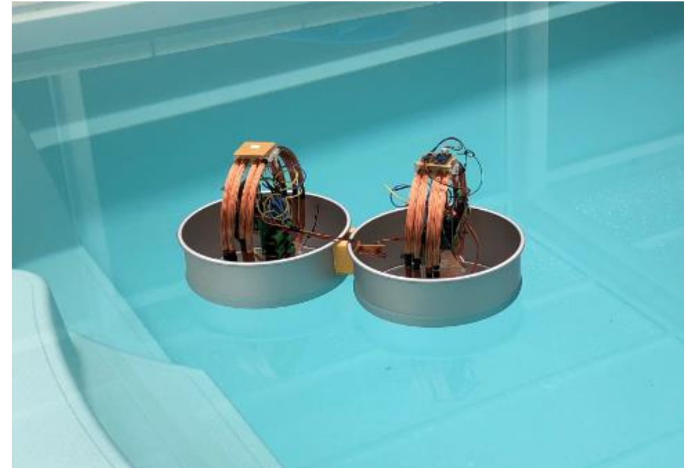
Bild: Zwei MCA Evaluierungs-Antriebe für ein Test-Wasserfahrzeug
